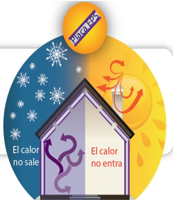
Figura 2. Aislamiento térmico de viviendas con placas de EPS.
